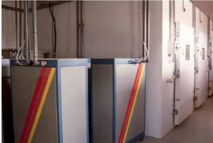
Cambres experimentals d'atmosfera controlada al campus de l'ETSEA de Lleida. (Centre UdL-IRTA)
