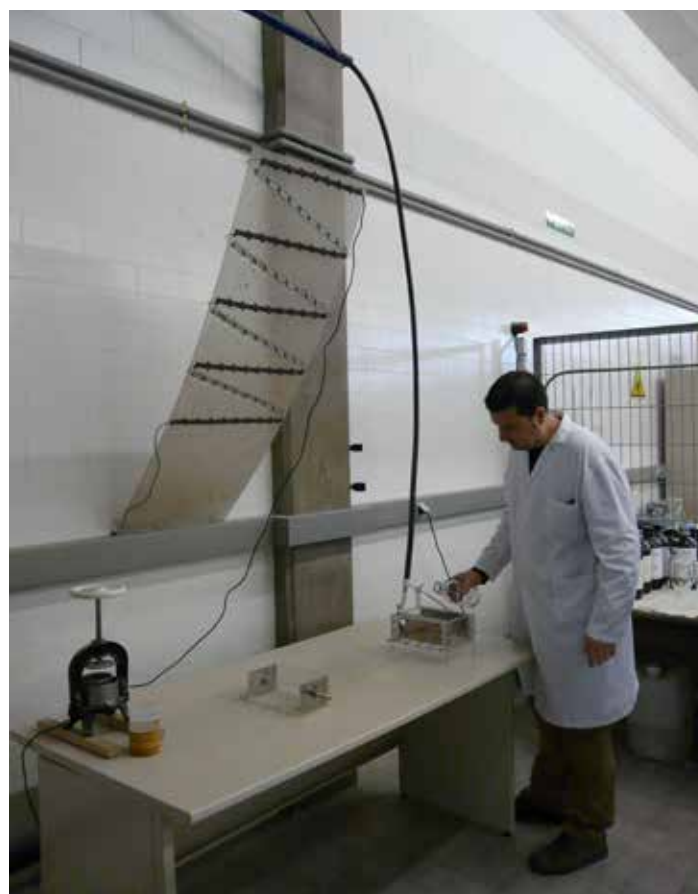
Equip de polsos elèctrics d'alta intensitat de camp per tractar aliments líquids.
