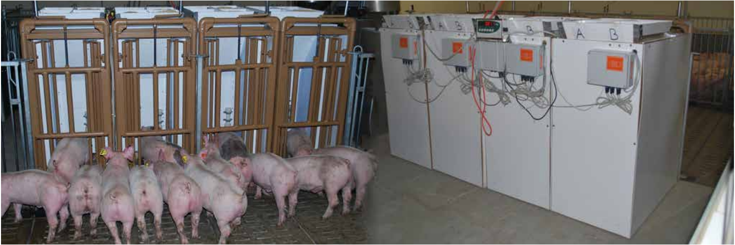
Equip de segona generació de sistema automàtic d'alimentació de precisió.
