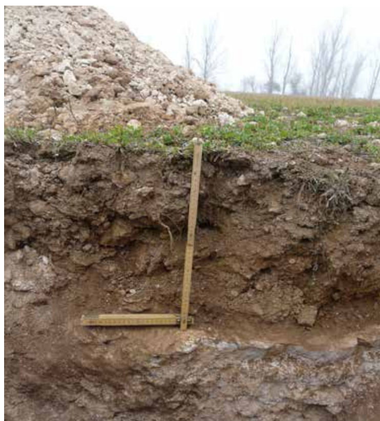
L'escandall és el medi per arribar a conèixer el perfil del sòl i poder determinar factors condicionants, en aquest cas la presència d'un endopèdon petrocàlcic fortament cimentat a menys de 50 cm de fondària. (J. Porta, 2011).
