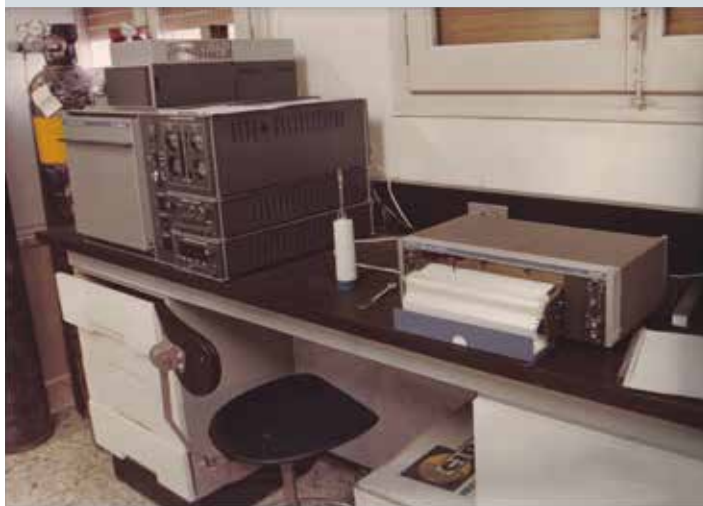
Cromatògraf de gasos adquirit per a l'anàlisi d'etilè, va ser un dels primers grans equips d'anàlisi instrumental de l'ETSEA.
